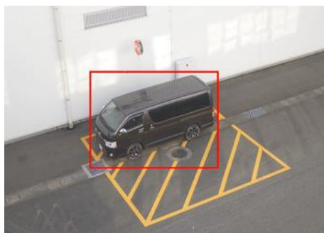
Detecção de Loitering Monitora tempo que veículo ou pessoas podem permanecer na área definida
