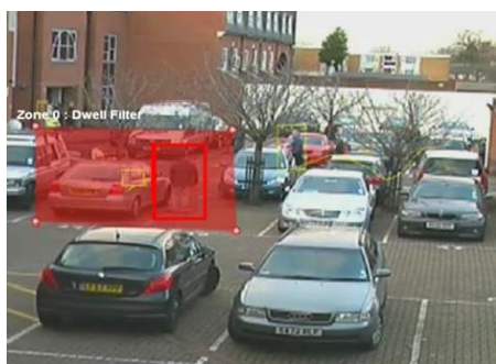
Monitoração Área Restrita Detecção de Intrusão
