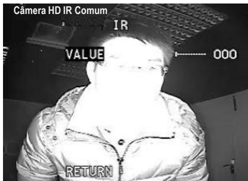
IR Inteligente – Evita efeito lanterna e saturação de luz na imagem
