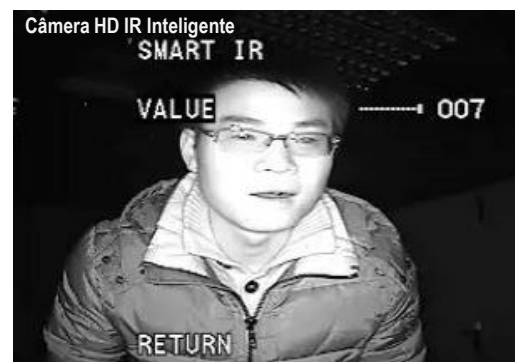
IR Inteligente – Evita efeito lanterna e saturação de luz na imagem
