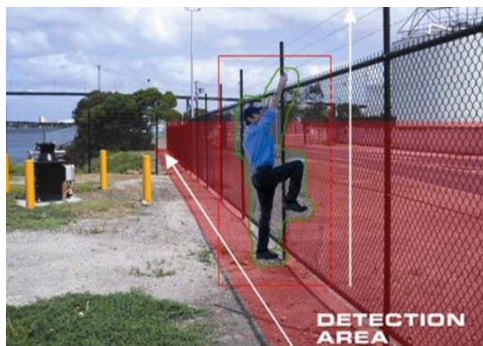
Detecção de Pessoas Monitora somente pessoas e ignora movimentos de folhagens, sobras
