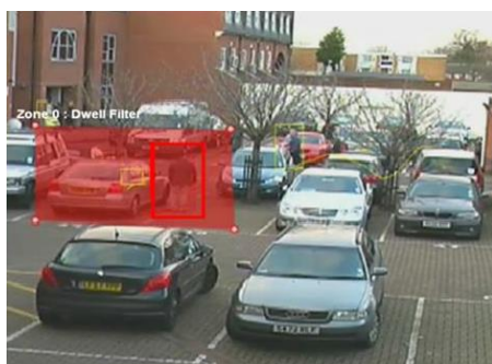
Monitoração Área Restrita Detecção de Intrusão
