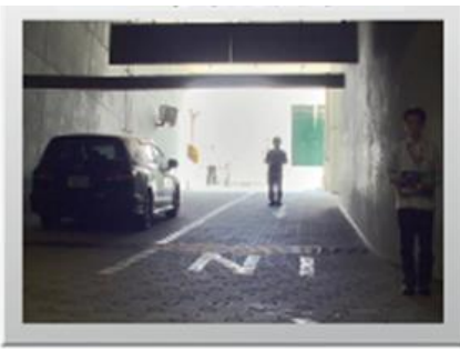
FUNÇÃO WDR (Uso Externo- Possibilita melhor imagem compensando luz de fundo e frontal)
