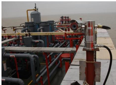
Offshore Pan/Tilt/Zoom Camera A Prova de Explosão
