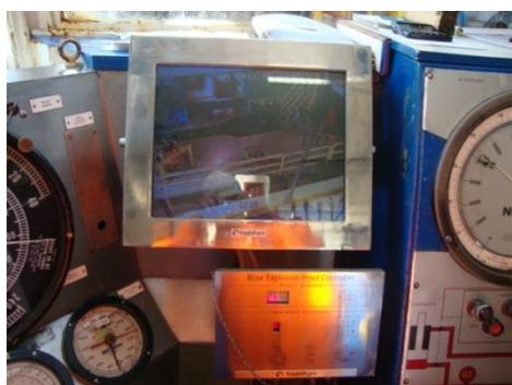
Navio com Monitor e Controlador A Prova de Explosão
