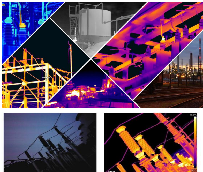
Monitoramento Óptico e Térmográfico na mesma câmera
