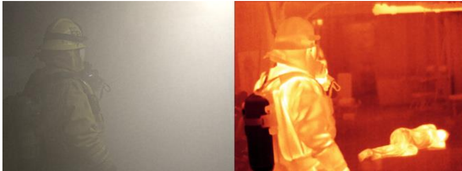
Câmera Integrada com Imagem Óptica IP Digital e Térmográfica Possibilita ver imagens em duplo segmento mostrando detalhes térmográficos
